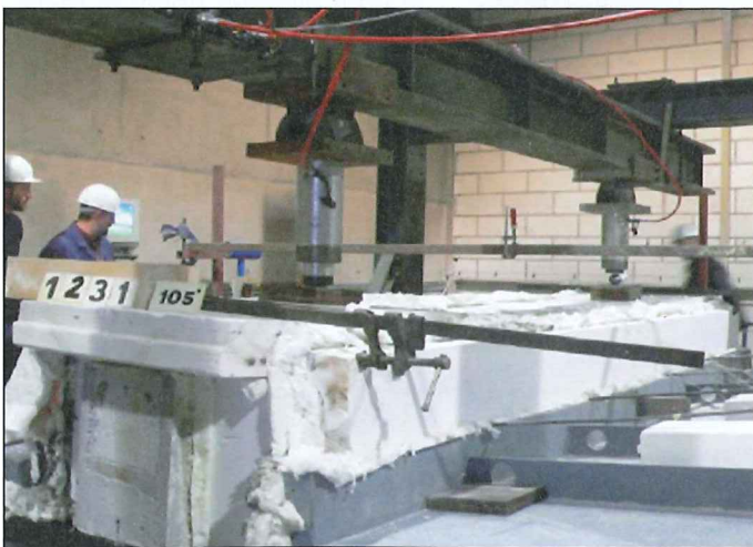
4. L'installazione di una trave in c.a. rinforzata con incamiciatura REFOR-tec® per la prova di resistenza al fuoco nei laboratori dell'Università di Liegi
